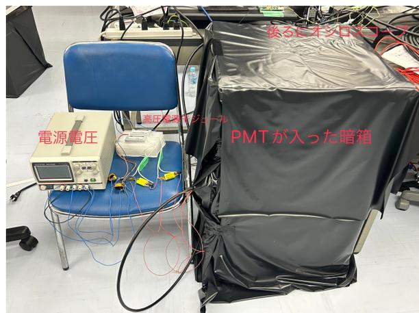
図 3.26 実際の PMT セットアップ
