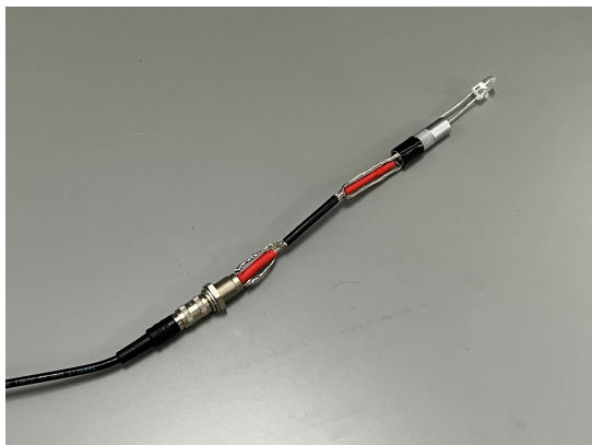
図 4.2 抵抗付き LED の接続
