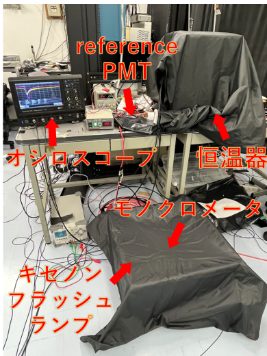
図 3.2 8 cm 径光電子増倍管の測定セットアップ
