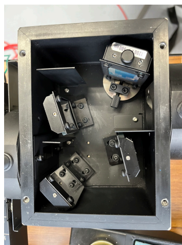
図 3.11 モノクロメータの光学系
