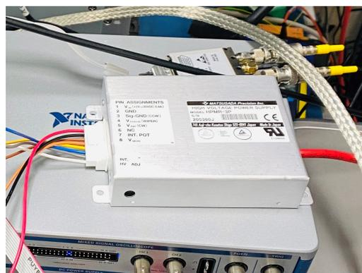
図 2.13 松定の高電圧電源
