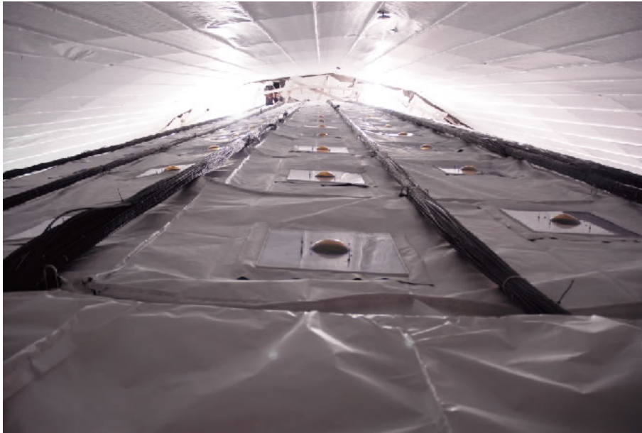
図 3 外水槽の光電子増倍管 [5] より引用
