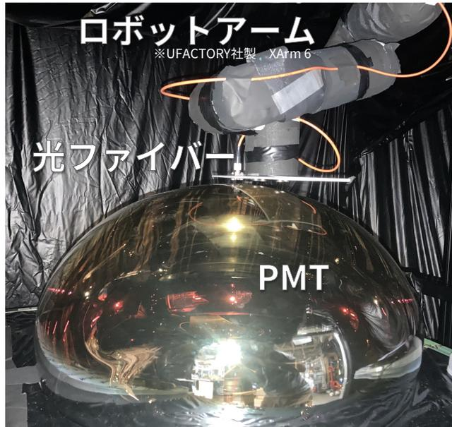
図 2.1: 光ファイバー先端がロボットアームに固定されており、ロボットアームを動かすことで任意の位置から PMT に光を照射できる。
