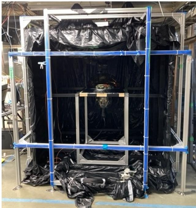
図 2.2: ヘルムホルツコイル。フレームに青いケーブルが巻かれ、電流が流れている。この中に暗室を用意し、測定を行った。
