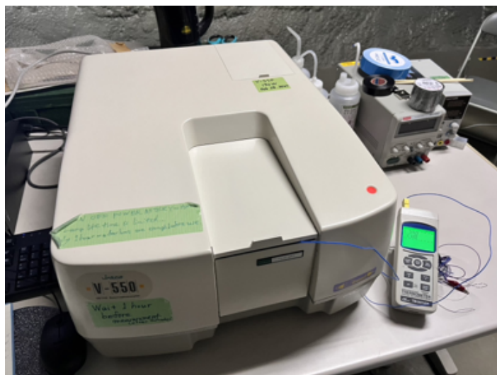
図 4.46 透過率測定の装置全体
