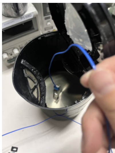
図 4.49 ガラスサンプルを熱湯で温めている様子
