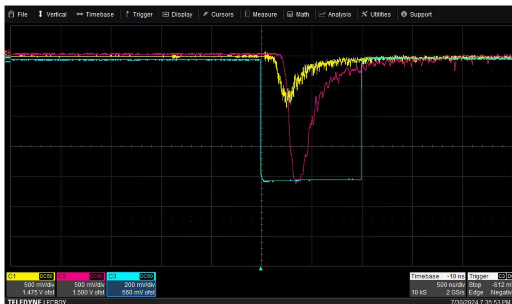
図 4.19 波長 400 nm の光を入射した際のオシロスコープの波形
