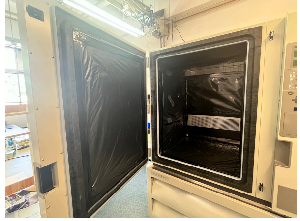
図 4.18 磁気シールドの上から暗幕を貼り付けた恒温槽内部
