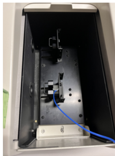
図 4.50 高温での透過率測定時のセルホルダー
