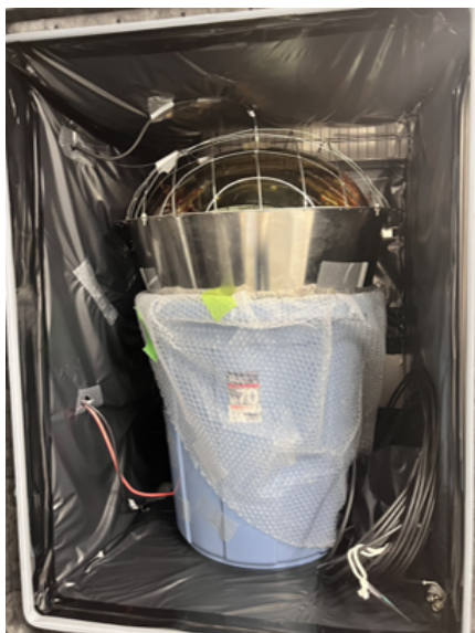
図 4.3 恒温槽に設置した 50 cm 径光電子増倍管 (R12860)
