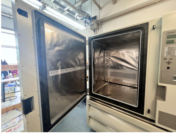
図 4.17 磁気シールドを貼り付けた恒温槽内部
