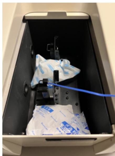
図 4.48 低温での透過率測定時のセルホルダー
