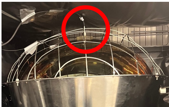
図 4.37 入射窓の中心に光を入射
