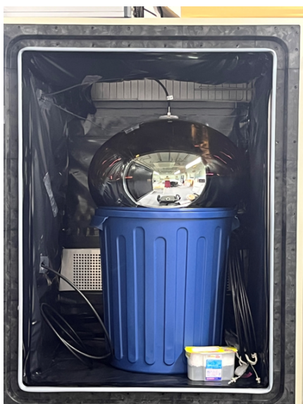
図 4.5 恒温槽に設置した 50 cm 径光電子増倍管 (R3600)
