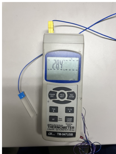
図 4.47 ガラスサンプルに温度センサを固定した温度計
