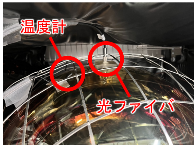
図 4.4 恒温槽に設置した 50 cm 径光電子増倍管 (R12860) の入射窓
