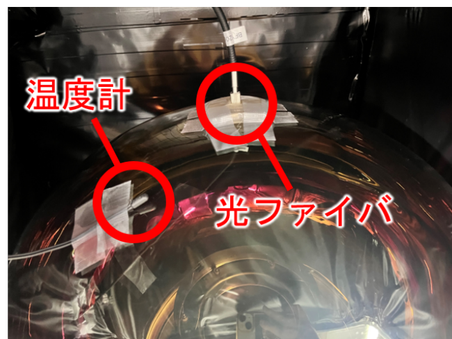
図 4.6 恒温槽に設置した 50 cm 径光電子増倍管 (R3600) の入射窓
