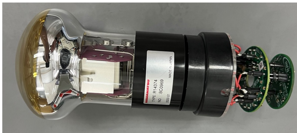
図 5.21: 光電子増倍管 R14374、CW 回路基板、デジタイザーの接続図
