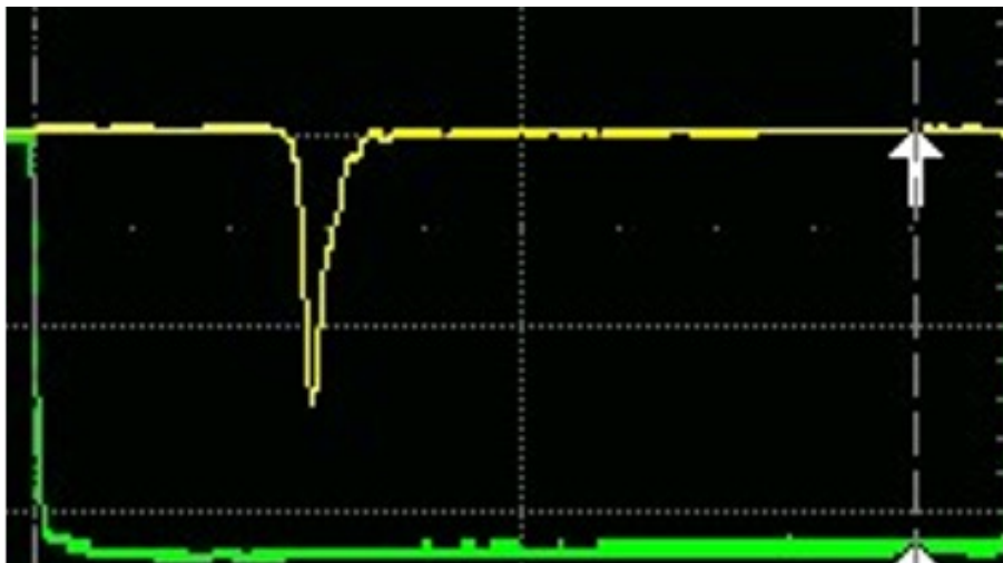
図 5.24: オシロスコープで観測される通常波形 (経線は 100 ns / division、緯線は 200 mV / division)
