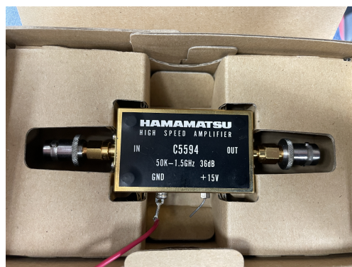
図 9.2: 浜松ホトニクス社の 36 dB アンプユニット C5594
