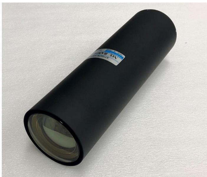
図 9 使用した PMT の写真
